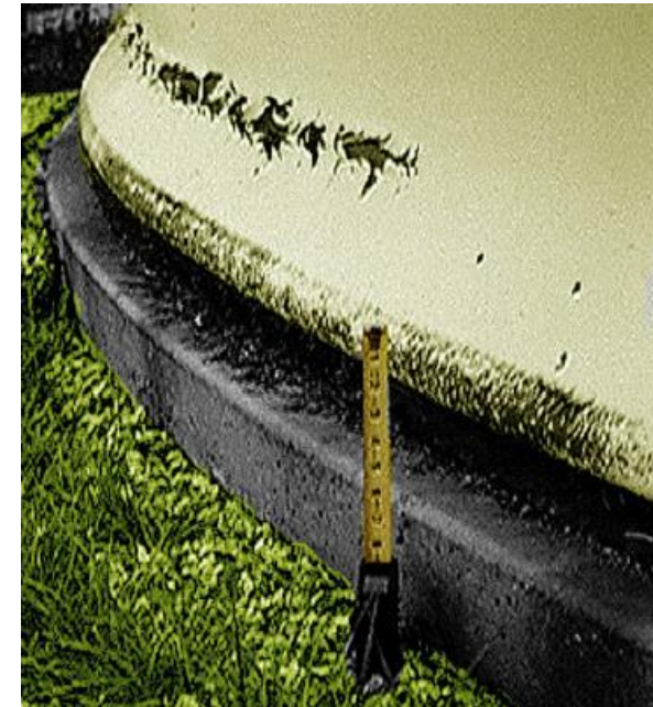
Oddělení nádrže od základu, porucha způsobená větrem
