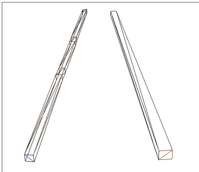
Obrázek 4.1: Porovnání reprezentace dvou těles (nalevo programem Microstation, napravo základní těleso z 3D Studia)
