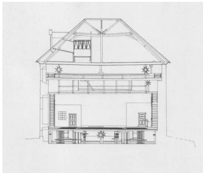
Obr. 1 Stav krovu před poslední úpravou, převzato z [2]
