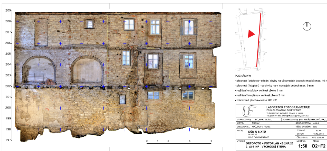
Obr.3: fotogrammetrická dokumentace – kompozice (ortofoto+fotoplán)
