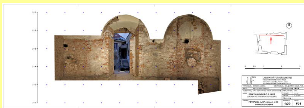
Obr. 4: Fotoplán severní stěny v místnosti č. 2.6 v 2. NP
