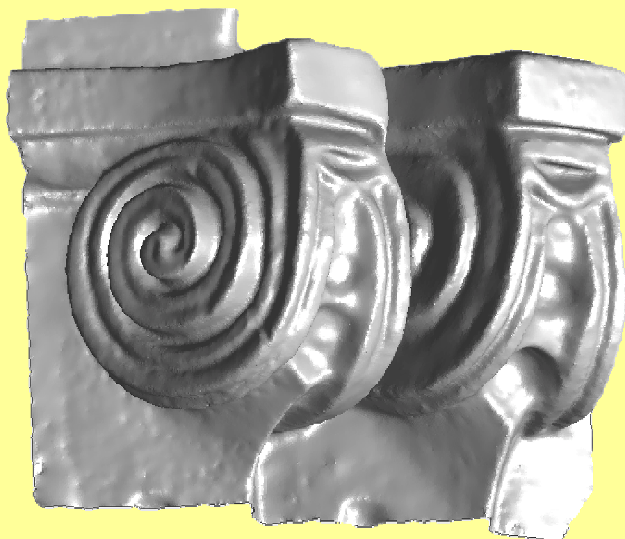
Obr. 2.1: Část detailního prostorového modelu ornamentální hlavice (pravý šnek bez textury)
