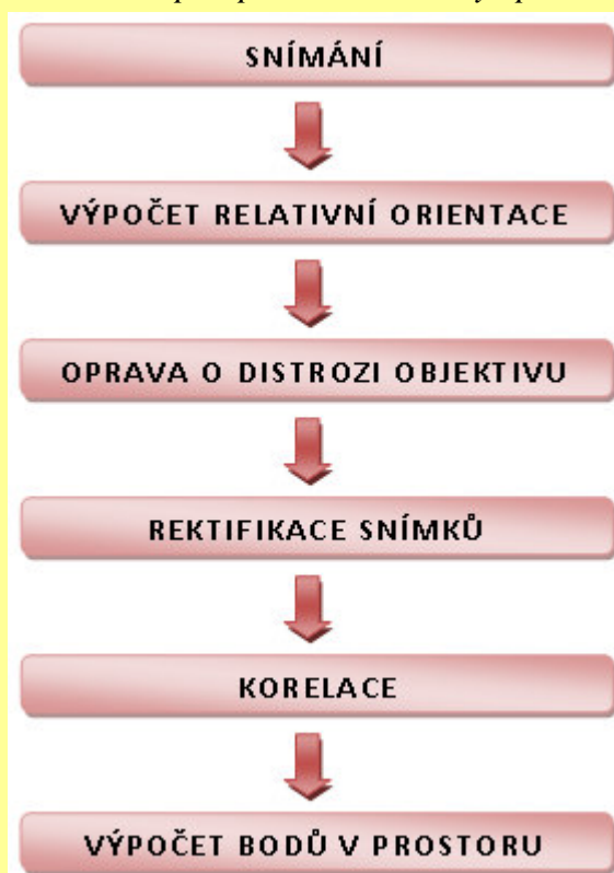
Obr.: Technologický postup práce v digitální fotogrammetrické stanici PhoTopoL ↑ a v programu Matlab při zpracování metody optického skenování ↓
