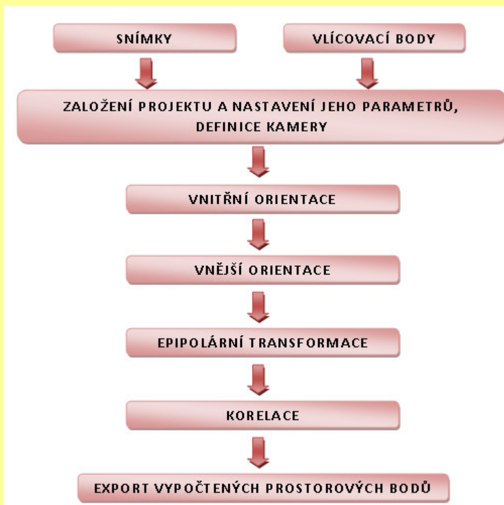
Obr.: Technologický postup práce v digitální fotogrammetrické stanici PhoTopoL ↑ a v programu Matlab při zpracování metody optického skenování ↓
