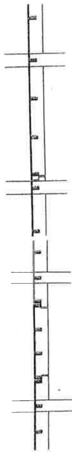
Obr. 5.66. Dilatace vytvořená vloženým polem stropní konstrukce.
