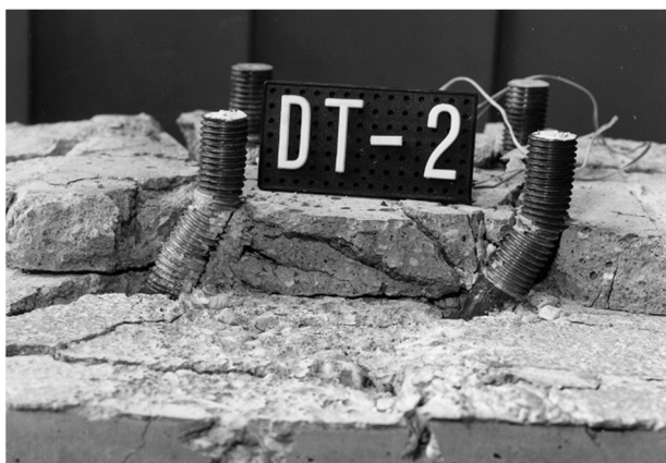
Obr. 4.20 Kotevní šrouby namáhané smykem a tahem
