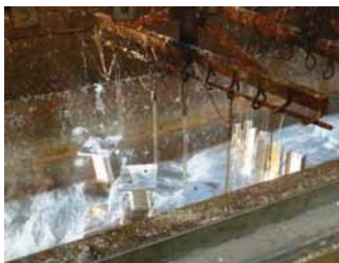
Obrázek 10: Žárové zinkování ocelových konstrukcí (a) Vyjmutí z lázně (b) Žárové zinkované nosníky se spřahovacími trny
