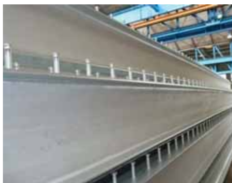
Obrázek 10: Žárové zinkování ocelových konstrukcí (a) Vyjmutí z lázně (b) Žárové zinkované nosníky se spřahovacími trny
