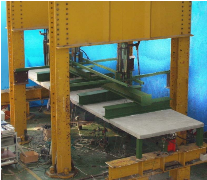
Zatížení řízeno silou (hydraulickými válci)
