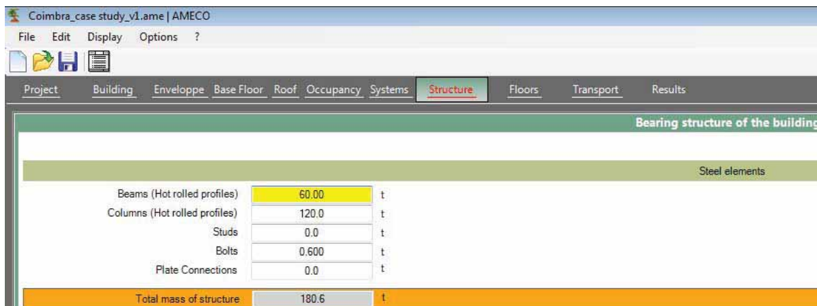
Obrázek 14 : Definování hmotnosti rozdílných ocelových konstrukčních prvků
