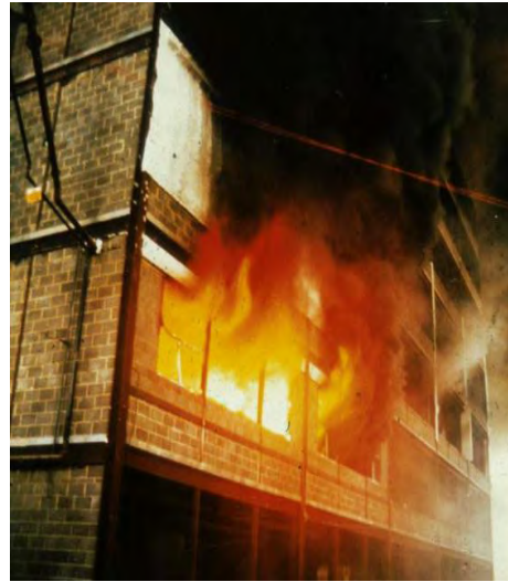
Obrázek 1.10: Požární zkouška č. 6 v Cardingtounu, a) konstrukce experimentálního osmipodlažního objektu; b) průběh požární zkoušky
