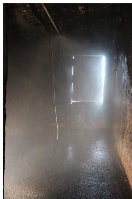
Obrázek 3.8: Zkušební místnost – po zapálení a po aktivaci sprinkleru
