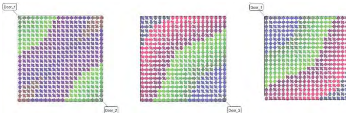
Obrázek 4.20: Pohyb jednotlivce v prostoru bývá definován potenciálovou mapou, její konkrétní podoba je ovlivněna mnoha faktory včetně způsobu propojení jednotlivých uzlů nebo počtu otevřených dveří
