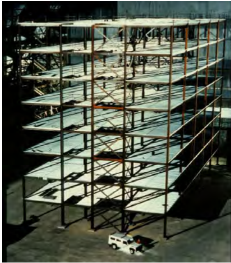
Obrázek 1.10: Požární zkouška č. 6 v Cardingtounu, a) konstrukce experimentálního osmipodlažního objektu; b) průběh požární zkoušky
