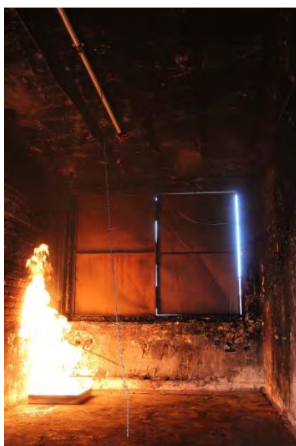
Obrázek 3.8: Zkušební místnost – po zapálení a po aktivaci sprinkleru
