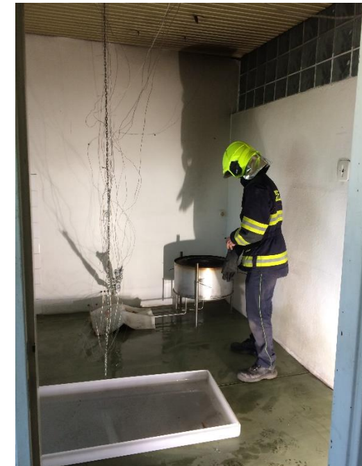
Místnost pro velkorozměrové měření reakce sprinklerových hlavíc
