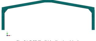
Fig. 21.7 FE Shell idealisation Mesh
