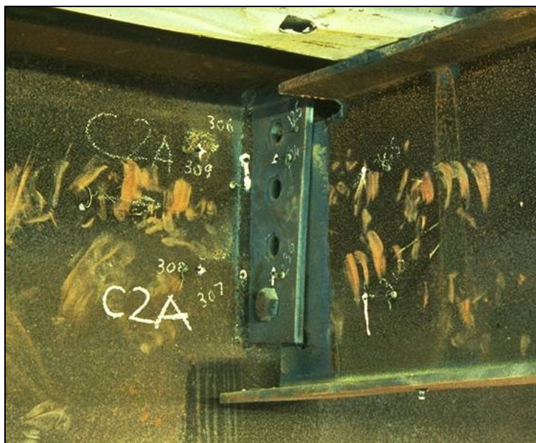
Sl. 2.8 Spoj s preklopno vezno pločevino po testu
