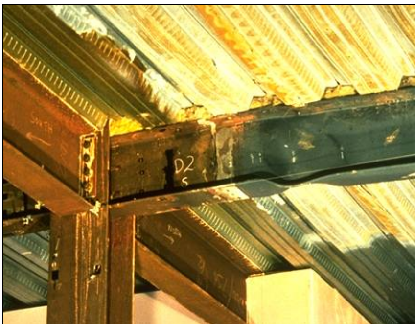
Sl. 2.5 Lokalno izbočenje na sovprežnem nosilcu
