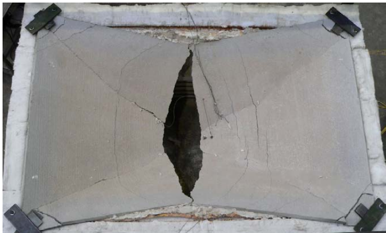
Sl. 4.6 Oblika porušitve testnih plošč pri povišanih temperaturah
