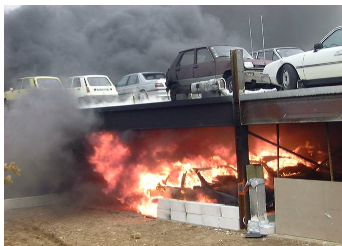
SI. 3.3 Močan požar, ki se je razvil med testom
