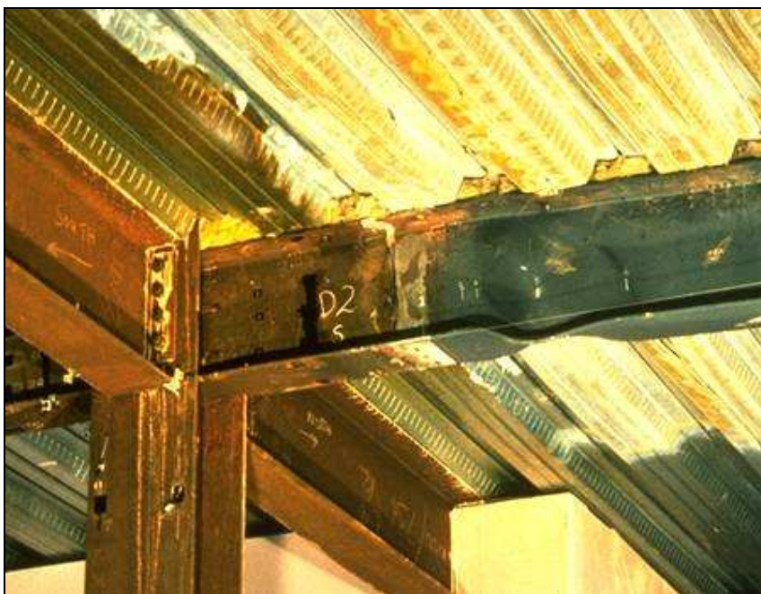
Rysunek 2.5 Wyboczenie półki w belce utwierdzonej
