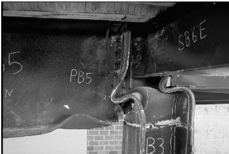
Rysunek 2.7 Zgnieciona w następstwie badania głowica słupa
