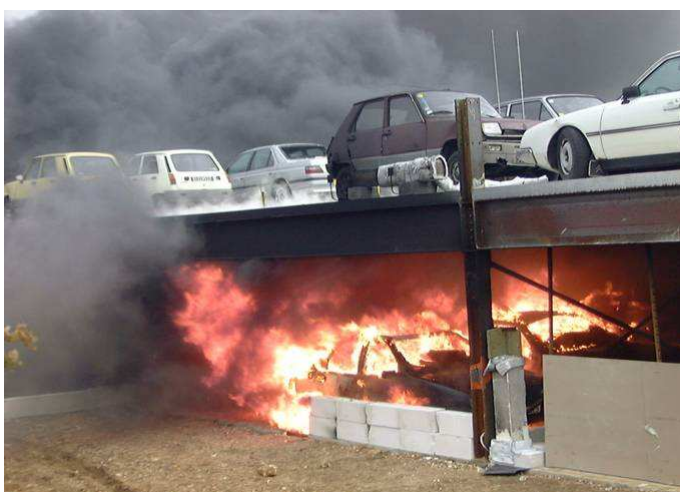
Rysunek 3.3 Pełne rozgorzenie pożaru podczas badania ogniowego
