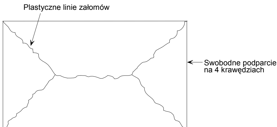
Rysunek 5.1 Typowy układ linii załomów w płycie prostokątnej swobodnie podpartej na czterech krawędziach
