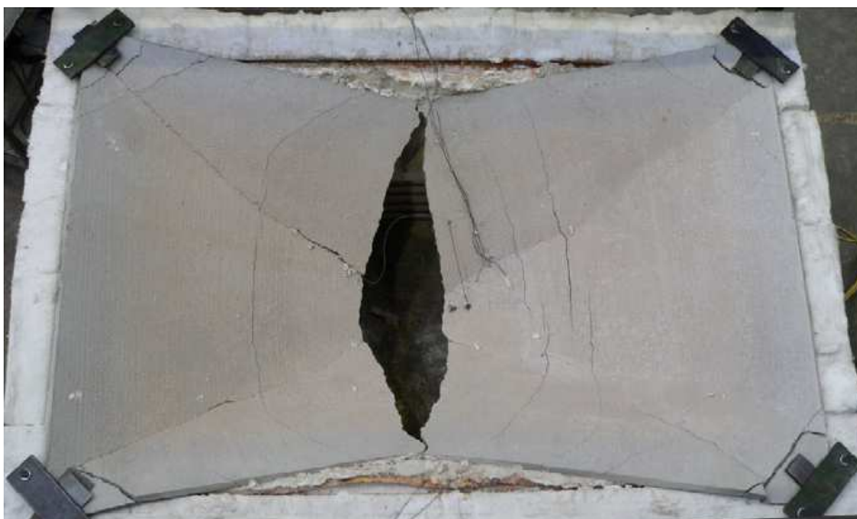
Rysunek 4.6 Mechanizm zniszczenia w badaniach płyt w podwyższonych temperaturach
