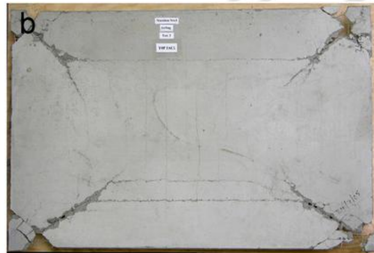
Zniszczenie przy ściskaniu betonu
