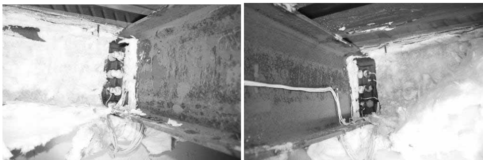
Obrázek 7.40 Stropnice připojená k průvlaku bez lokálního boulení
