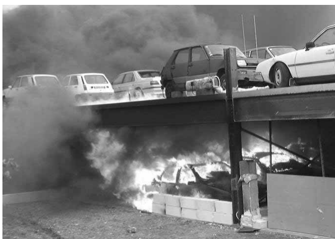
Obrázek 3.3 Plně rozvinutý požár během požární zkoušky
