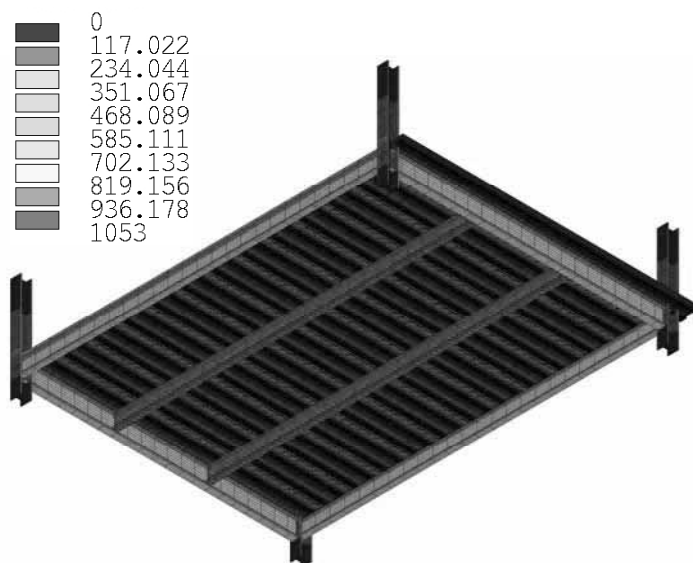
Obrázek 8.6 Rozdělení teplot ve 120. min požáru
