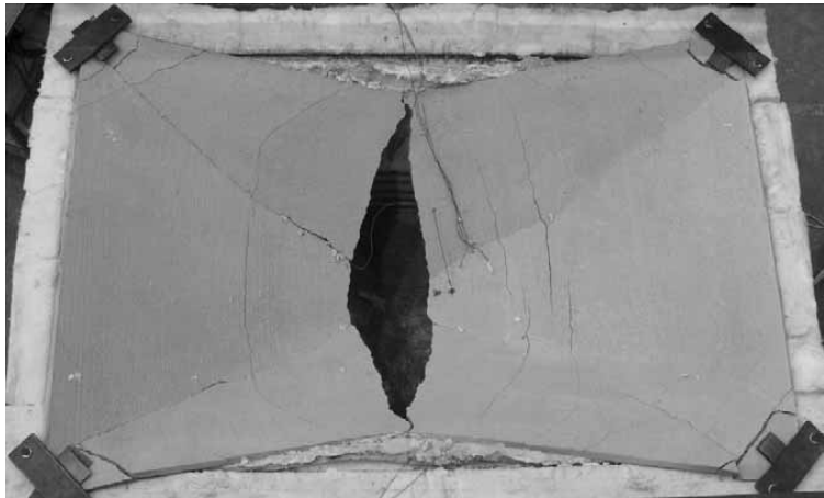
Obrázek 4.6 Tvar porušení při zkouškách desek za zvýšené teploty
