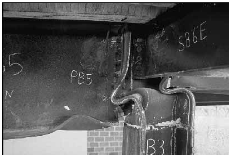
Obrázek 2.7 Zkrácená horní část sloupu po zkoušce č. 2: Rovinná soustava
