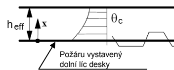
Tabulka 0-1 Rozdělení teplot v desce pro h_{\text{eff}} , max = 150 mm při vystavení teplotě podle nominální normové teplotní křivky 30 až 180 min
