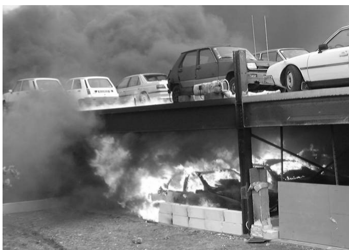
Obrázek 3.3 Plně rozvinutý požár během požární zkoušky
