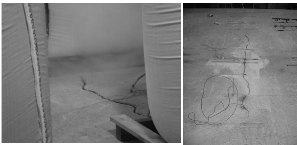
(a) Praskliny ve středu stropní desky při zkoušce
