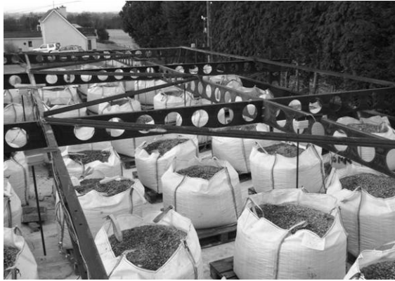
Obrázek 7.49 : (a) Zatížení pytlí, (b) Dřevěné latě pro požární zatížení
