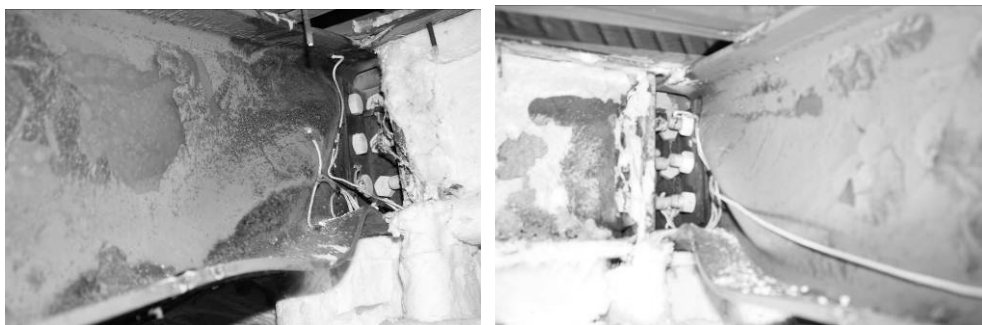
Obrázek 7.39 Lokální boulení nechráněné stropnice u sloupu
