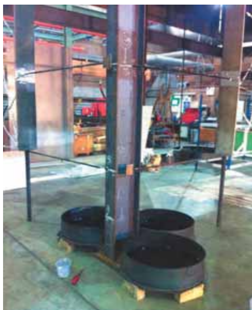
Obrázek 3.4 Uspořádání zkoušky v laboratoři FireSERT, vlevo pánve s kapalným palivem a vpravo dřevěné hranice
