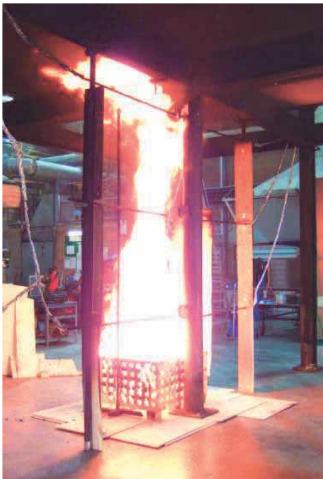
Obrázek 3.5 Požár zasahující strop
