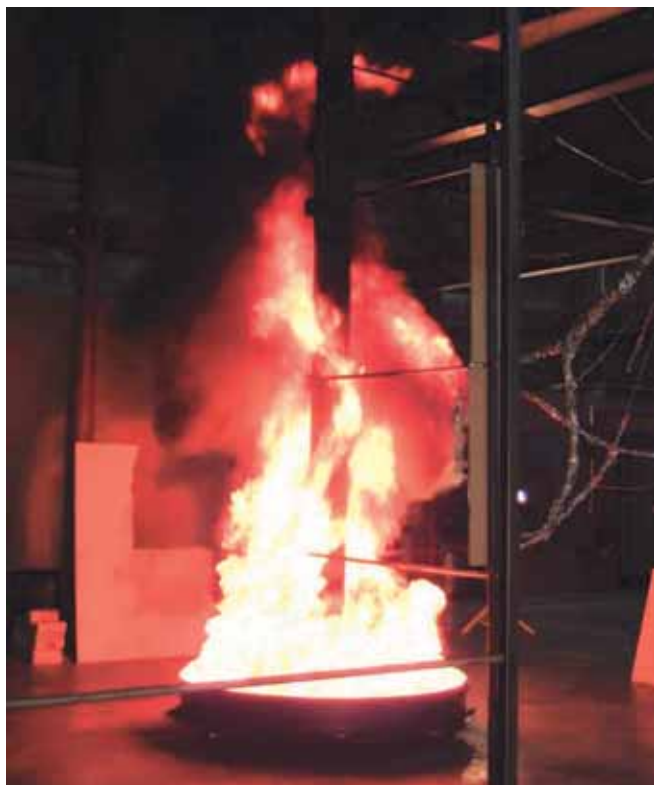
Obrázek 3.1 Zkouška zahřívání sloupu lokálním požárem
