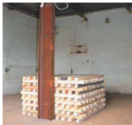
Obrázek C.25 Požární zatížení (vlevo), Sloup před lokálním požárem (vpravo)
