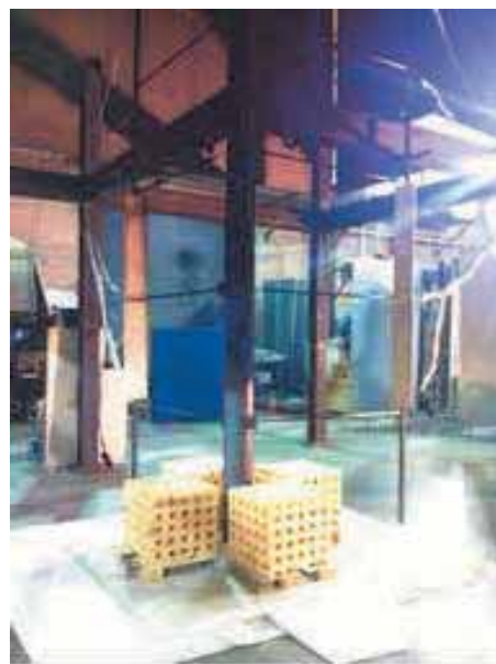
Obrázek 3.4 Uspořádání zkoušky v laboratoři FireSERT, vlevo pánve s kapalným palivem a vpravo dřevěné hranice
