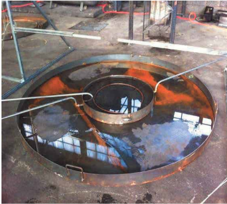
Obrázek 3.3 Přidávání paliva při zkoušce s pánví o průměru 2 m, viz LOCAFI Deliverable 15 [14]
