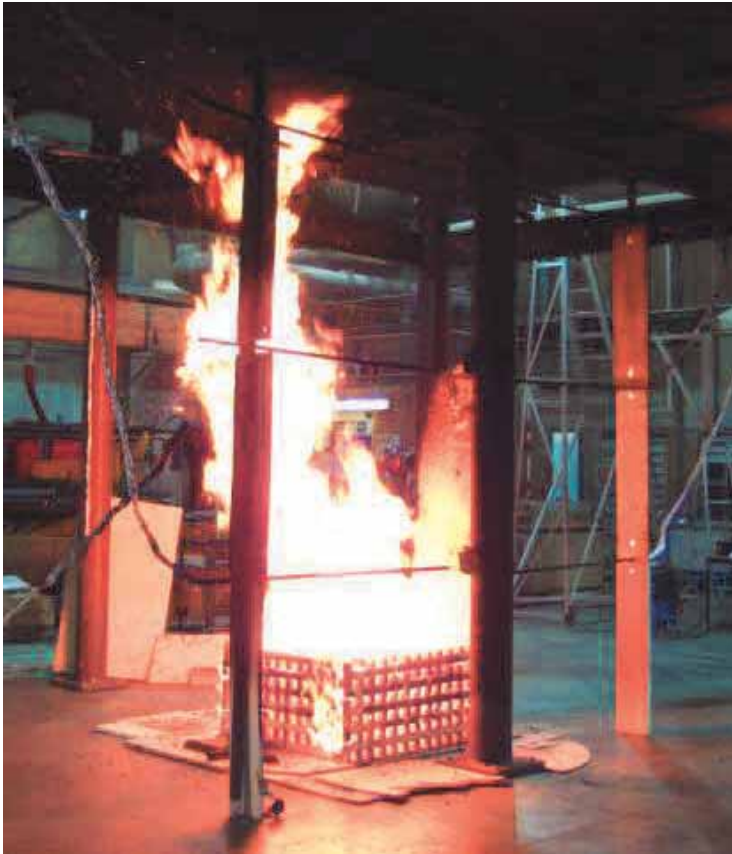
Obrázek 3.7 Zkouška Strop - O36 s náklonem plamene
