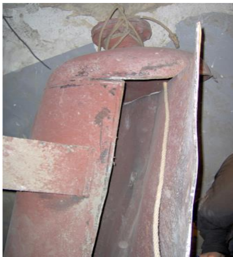
Obr. 22. Pohled na roztržený podélný svár [2,3,5].
