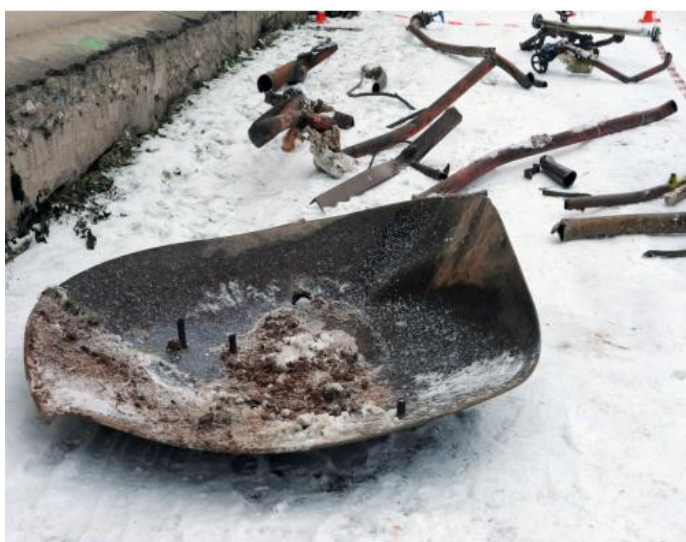
Obr. 35. Část klenutého dna s hmotností 320 kg ve vzdálenosti 2 km od místa původního umístění [90].
