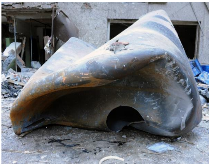
Obr. 37. Odlomená část luby nádoby s klenutým víkem o hmotnosti 2 000 kg [90,266] se otočila o 180 ° a zabořila mezi návěs a kabinu kamionu.
