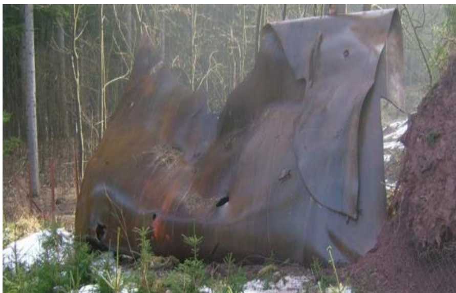
Obr. 38. Zbýlá část pláště nádoby o hmotnosti 4 500 až 4 800 kg [90] odlétla do lesa do místa vzdáleného cca 400 m.
