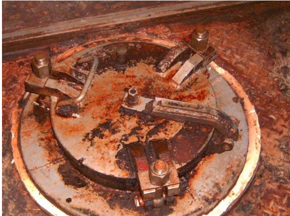
Obr. 19. Pohled na matici na šroubu plnicího víka destrukturu [2,3,5].
