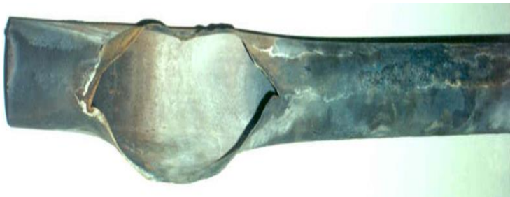
Obr. 15. Detail roztržené varné trubky parního kotle [2,3,5].
