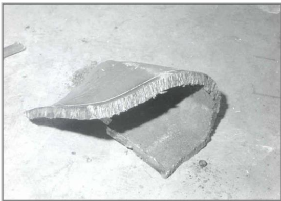
Obr. 4. Úlomek kotle nalezený mimo budovu kotelny [2,3,5].
