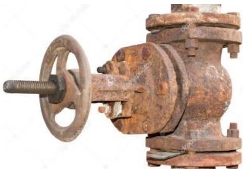
Obr. 9. Příklad vnější koroze; zpracováno dle obrázku [89].
