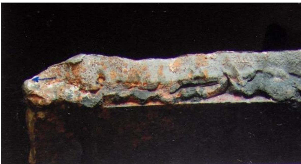
Obr. 25. Vzhled povrchu roztrženého podélného svaru v oblasti styku s obvodovým svarem. Šipkou je vyznačena poloha dna svaru A; šířka odlomené části 3.5 mm [2,3,5].
