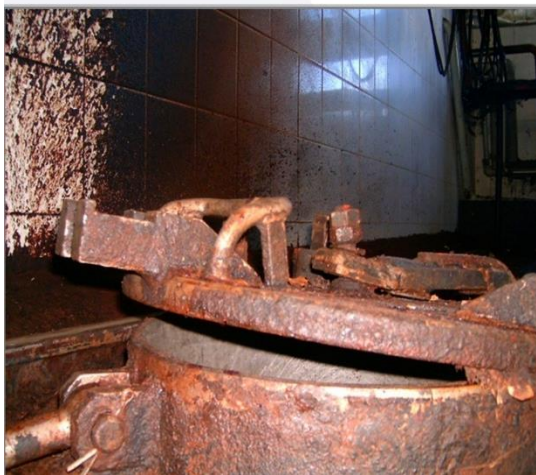
Obr. 20. Pohled na mezeru na šroubu plnicího víka destrukturu [2,3,5].
