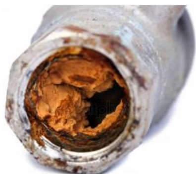
Obr. 10. Příklad vnitřní koroze; zpracováno dle obrázku [89].
