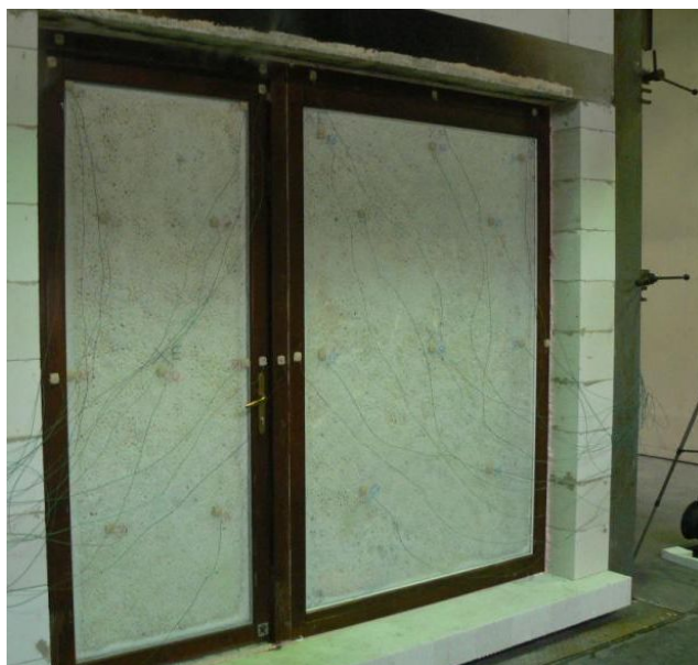
Obr. 3 – ZK PO – prasknutí vnitřního skla a aktivace požárně odolného gelu čas: 6 minut ( www.geusokna.cz - peklo-za-dveřmi)
