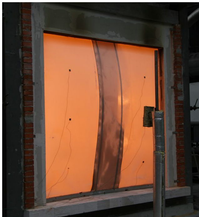
Obr. 10 – Textilní roletový uzávěr – požární zkouška ( www.avaps.cz )
