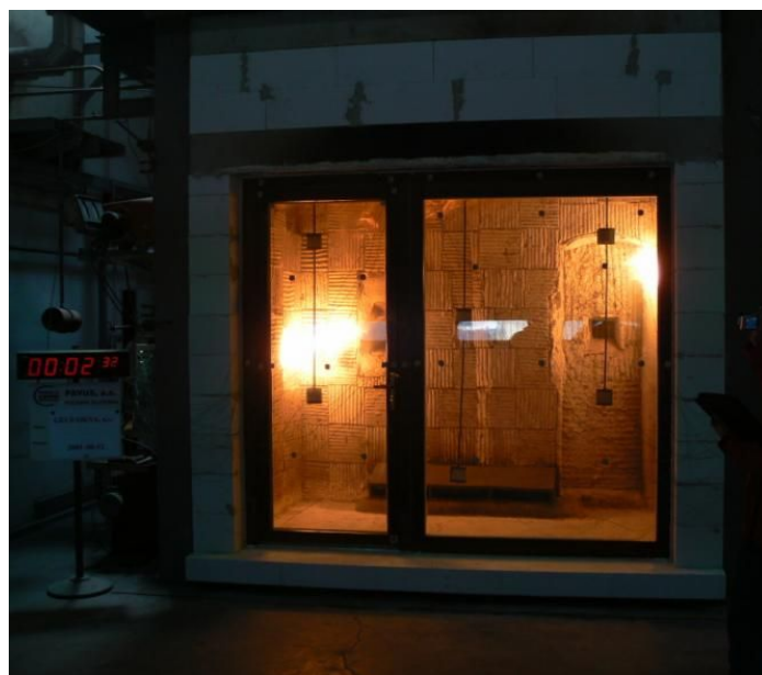
Obr. 2 – Zkouška požární odolnosti (ZK PO) – připojena teplotní čidla, zažehnutí dvou naftových hořáku, čas: 0:00:00 ( www.geusokna.cz - peklo-za-dveřmi)
