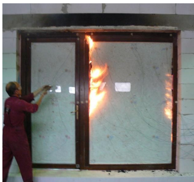
Obr. 4 – ZK PO – prošlehnutí, čas: 0:42:28 è EI 30 ( www.geusokna.cz - peklo-za-dveřmi)
