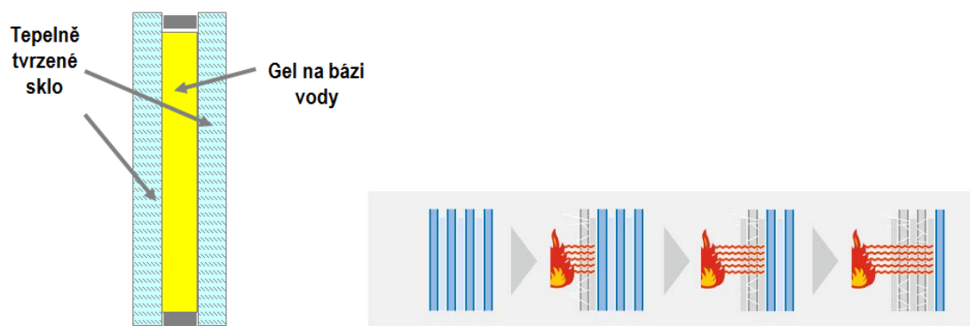
Obr. 5 Skladba tepelně tvrzeného skla s vrstvou gelu a jeho chování při požáru [1], [2]
