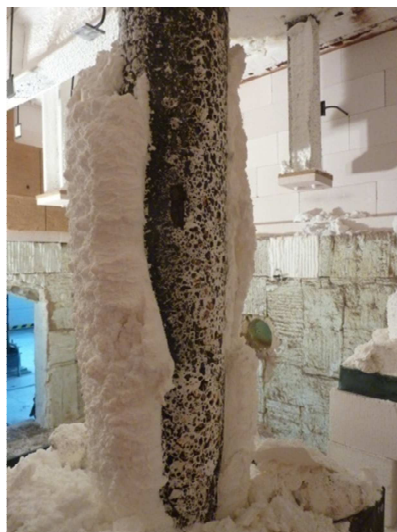
Obr. 10 Tloušťka napěněné funkční vrstvy je nesrovnatelně větší než tloušťka původního nátěru.
