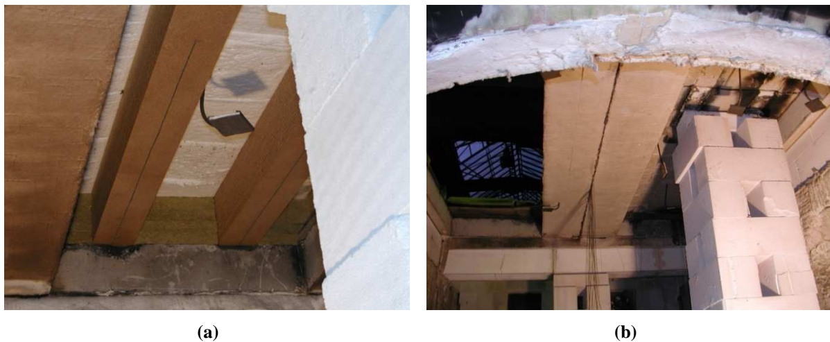
Obr. 11 Požární zkouška intumescentního nátěru na dřevěné konstrukci; (a) nosník před zkouškou, (b) po zkoušce
