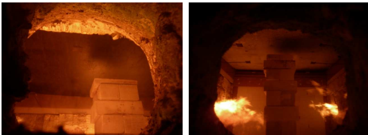
Obr. 15 Průběh požární zkoušky intumescentního nátěru na betonové desce
