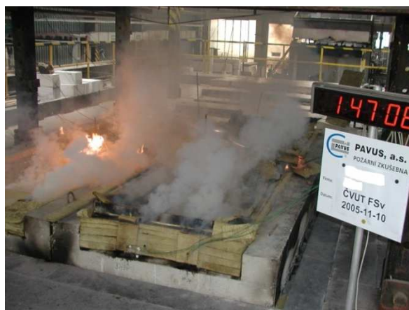
Obr. 12 Pohled na zkušební pec během požární zkoušky
