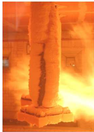
Obr. 5 ETH Zürich: Zkušební těleso během požární zkoušky; vlivem vysokých teplot dochází k vypěnění aktivní zpěňující vrstvy, která vytváří izolační bariéru o mnohonásobném objemu. Protože schopnost nátěru roztahovat se ve více směrech je omezená, vznikají výrazné praskliny, které mohou způsobit opadávání části nátěru.
