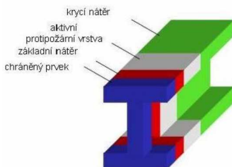
Obr. 2 Struktura intumescentního nátěru [3]
