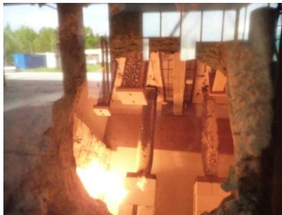
Obr. 8 Průběh požární zkoušky na ocelových prvcích
