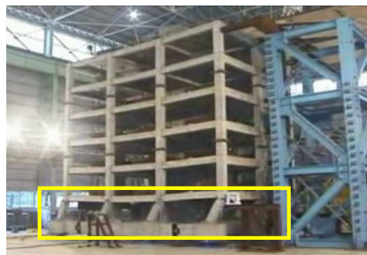
Obr. 22 Výsledek zkoušky ŽB skeletu s malou duktilitou styků na vibračním stole (převzato z en.wikipedia.org/wiki/Earthquake_engineering)
