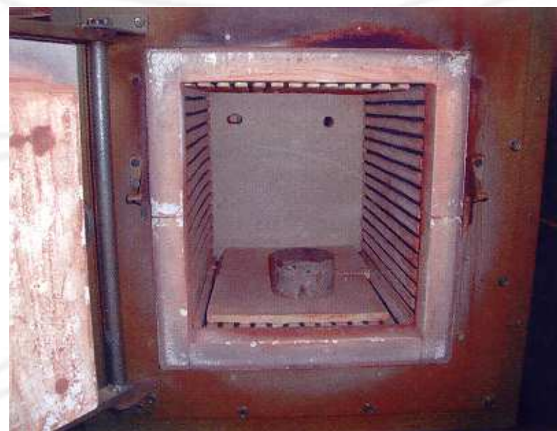
Zkoušky vzorků v požární peci
