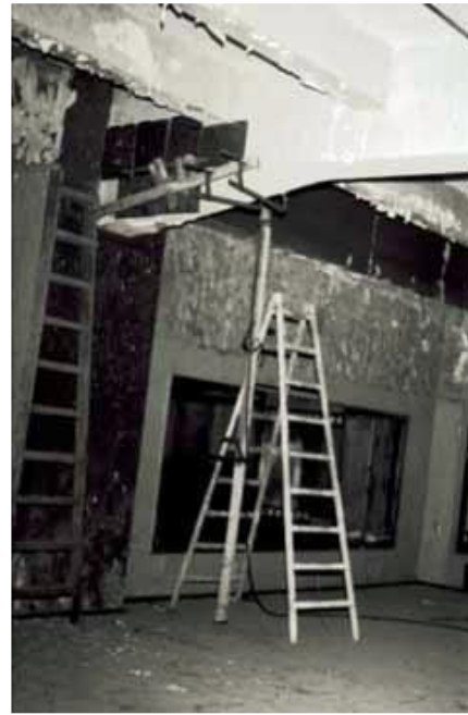
Obrázek 11: Jádrové vrtý a gama grafické prozáření prvku [3]
