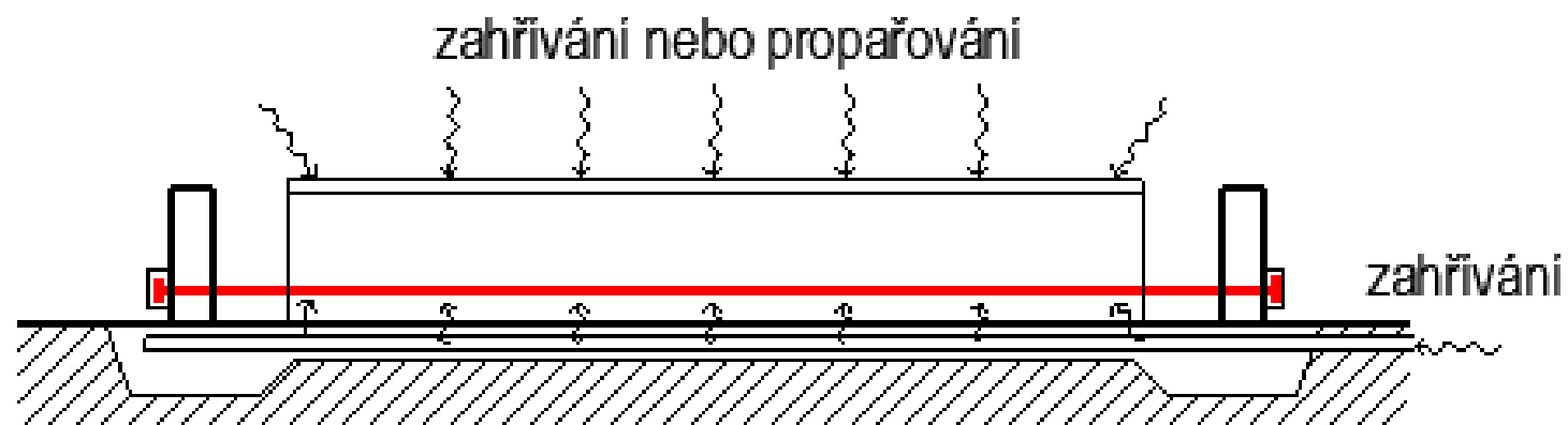
c) urychlené tvrdnutí betonu
