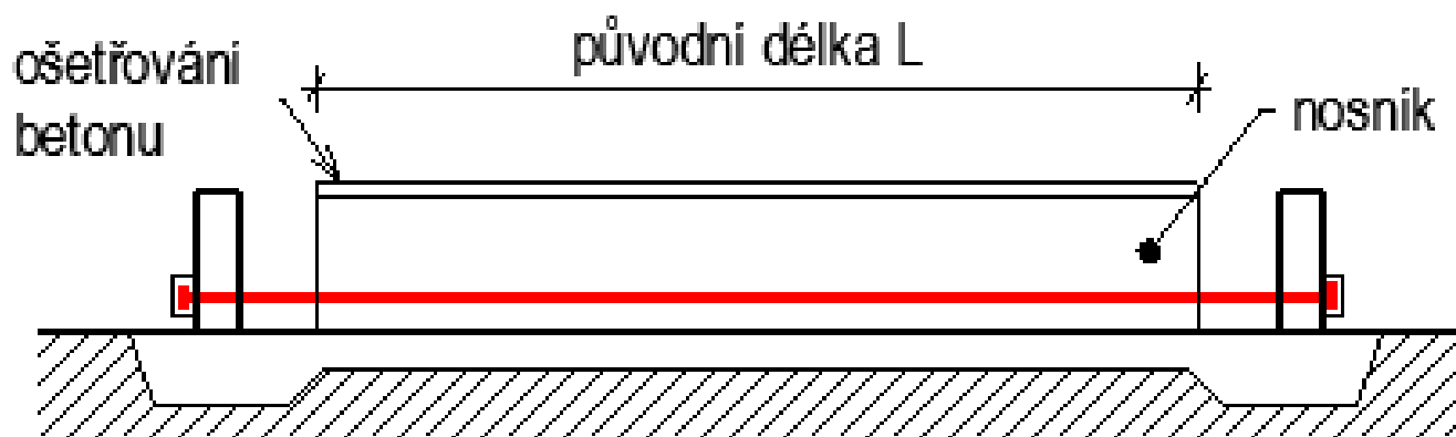
b) betonování a ošetřování betonu
