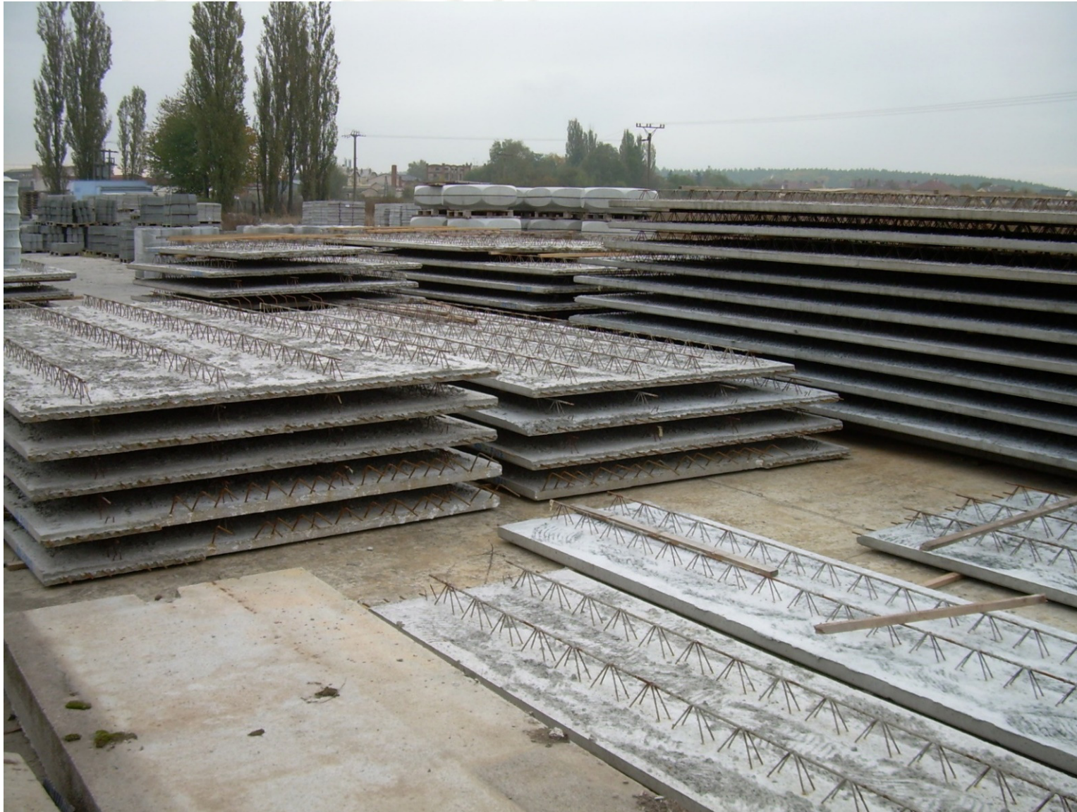
Prefabrikáty spřažené betonové stropní desky
