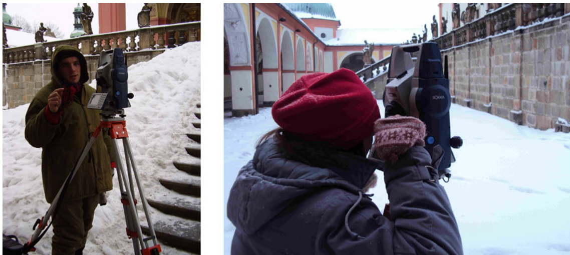
Obrázek 4.5.: Měření s totální stanicí Set3X
