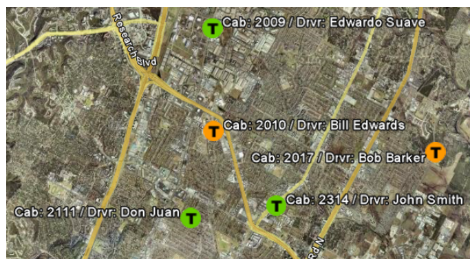
Obrázek 4.1: Ukázka aplikace KML Google Earth na realtime vizualizaci polohy automobilů taxi služby pomocí software FME (zdroj: vlastní zpracování)
