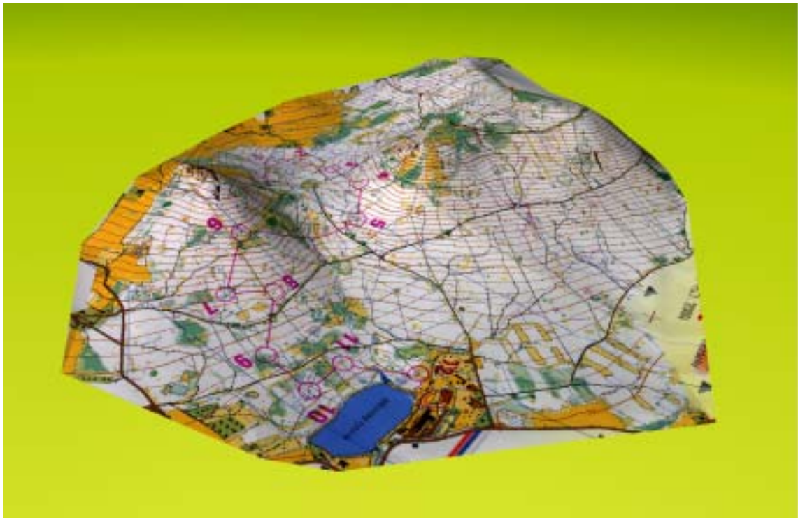
Orientační mapa lokalita Nové Město na Moravě – Milovy. Měřítko mapy 1:15 000, ekvidistance vrstevnic 5 m. Vrstevnice získány vektorizací z naskenované mapy. Výškové zkresení 3x. Interval vrstevnic použitých pro generování modelu – 25m. Nahore model tvořený uzlem ElevationGrid , dole model tvořený uzlem IndexFaceSet .
