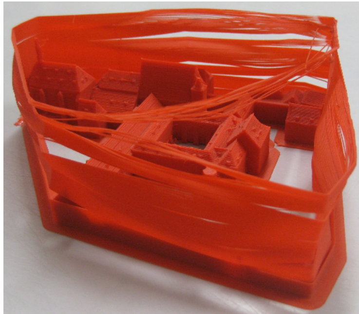
Obr. 1.3: Vytisknutý model s ochrannou vrstvou
