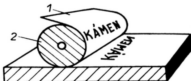
Obr. 8 Litografie (1 – papír, 2 – tlakový válec) [11]
