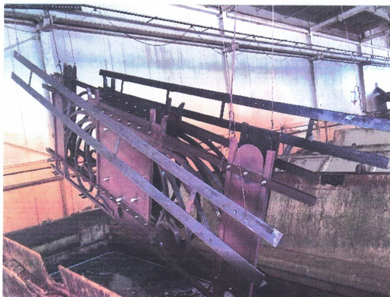
Obr. 8 Moření před aplikaci žárového zinku ponorem
