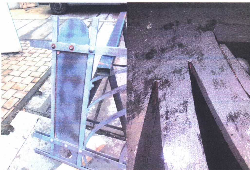
Obr. 4 Předúprava povrchu tryskáním před aplikaci žárového zinku ponorem
