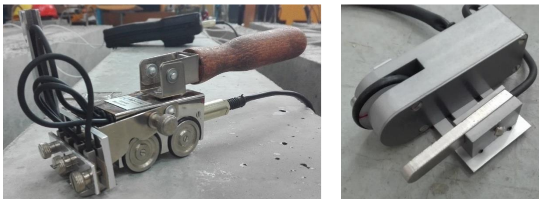
Obr. 35 Skenovací zařízení – vozíček a jednotlivá sonda
