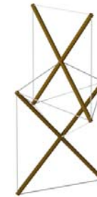
princip věže podle Snelsona (1948)
