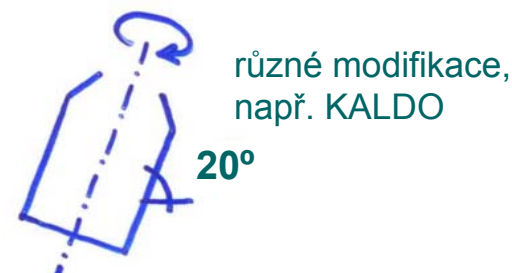
Kaldo proces (prof. Kalling z Domnarvetu) (zcela výjimečně, pro železo s fosforem, až 2% P)
