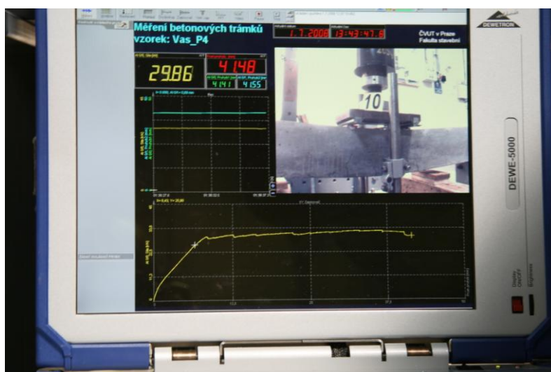
Obr. 20: Vyhodnocení zkoušky – závislost ohybového momentu od zatížení a průhybu.
