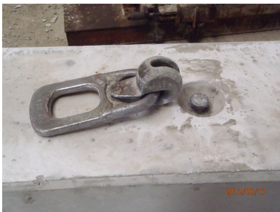
Obr. 21 Finální podoba úchytu "Trn s kulovou hlavou" + zvedací oko
