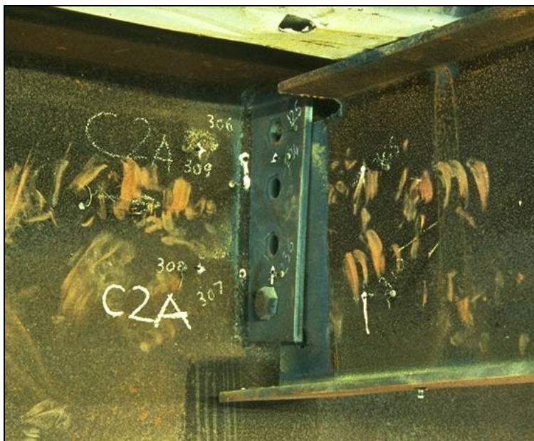
Figura 2.8 Unión de cartelas tras el ensayo
