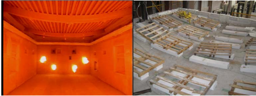
Figura 7.38 Forjado ensayado durante y después del fuego
