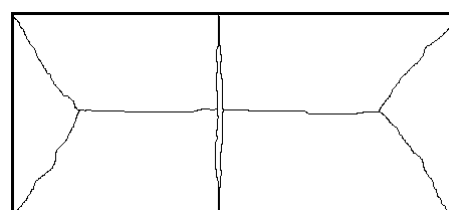
(b) Formación de grietas en el centro de la losa
