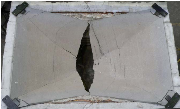
Figura 4.6 Modo de fallo en losas de ensayo a temperaturas elevadas
