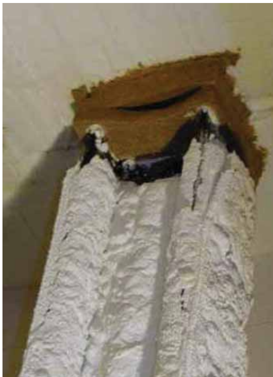
Obrázek 1.4: Napěnění intumescentního nátěru při působení zvýšených teplot [20]
