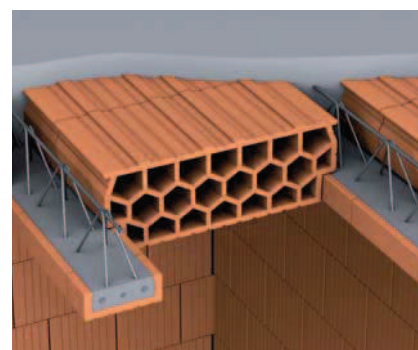
Uložení stropní vložky MIAKO mezi POT nosníky
