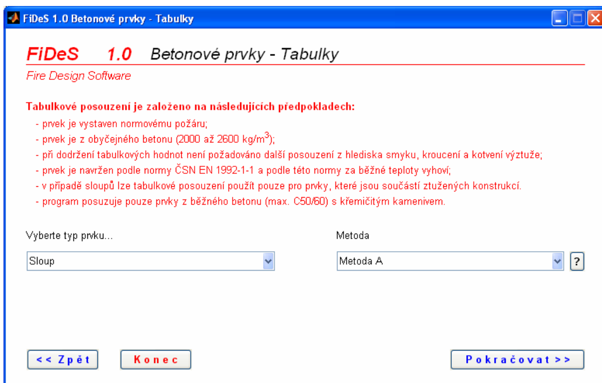
Obr. 5.1 Úvodní okno programu pro posouzení požární odolnosti vybraných betonových prvků pomocí tabulek uvedených v normě ČSN EN 1992-1-2
