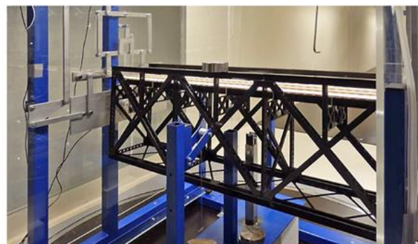
Obr. 29 Stanovení zatížení větrem na příhradový most ve větrném tunelu
