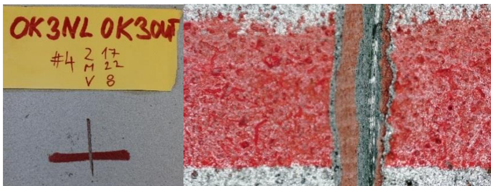
Obr. 22 Ukázka destruktivního měření tloušťky a stanovení skladby OPS - základní nátěr 170 \mu\text{m} , mezivrstva 220 \mu\text{m} a vrchní nátěr 80 \mu\text{m} (vlevo); mikrosnímek měřeného řezu (vpravo)
