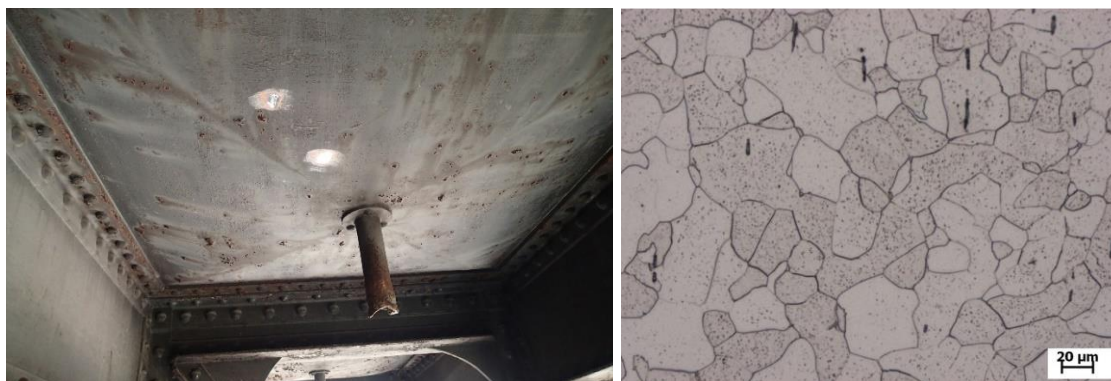
Obr. 42 Osazená puklovka s odvodněním a Mikrostruktura materiálu, zvětšení 200x
