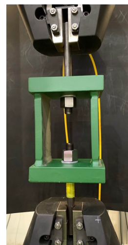
Obr. 2 a) Únavová křivka šroubovaného spoje tyčí zesílení a b) zkušební přípravek při únavové zkoušce
