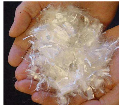
Obr. 2.4: (vlevo) Polymerová makro-vlákna BaneSteel 55 [38], (vpravo) mikrovlákna Fibribet [39].
