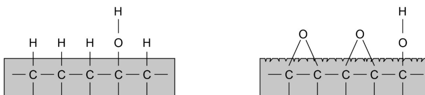
Obr. 2.11: Princip plazmatické modifikace povrchu vláken: (vlevo) neupravený vzorek zakončený vodíkovými vazbami s původní morfologií povrchu, (vpravo) vzorek upravený kyslíkovým plazmatem, u kterého došlo k nahrazení vodíkových vazeb a změně morfologie povrchu [4].
