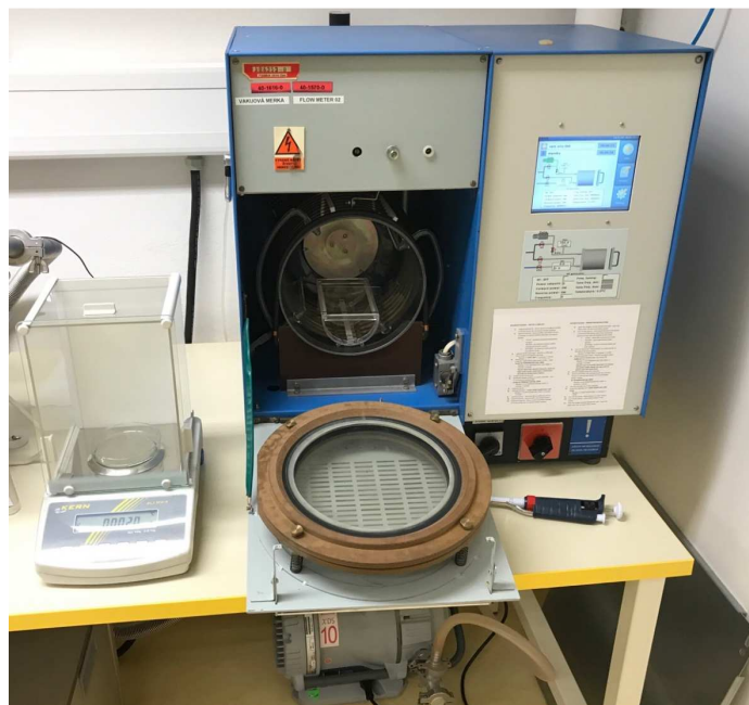
Obr. 3.2: Plazmatický přístroj Tesla VT 214.
