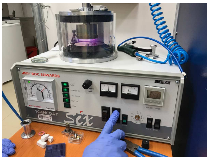
Obr. 3.5: Příklad přístroje pro pokovení vláken BOC Edward Scancoats Six.
