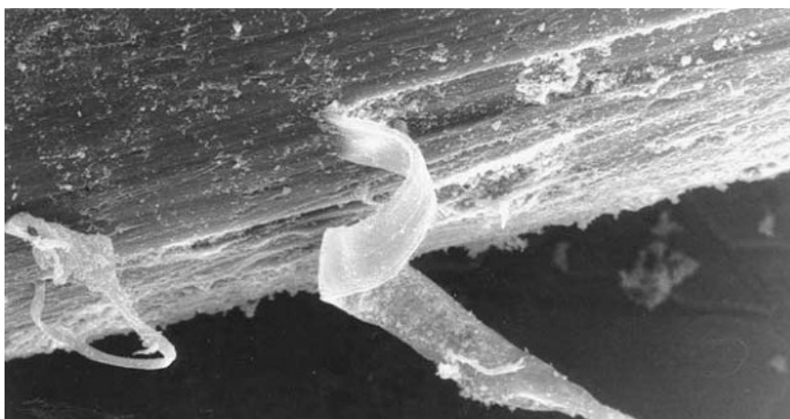
Obr. 2.7: Snímek z rastrovací elektronové mikroskopie mechanického poškození povrchu PO vlákna [44].
