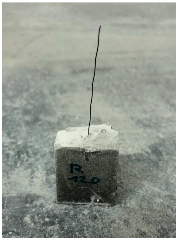
Obr. 3.7: Zkušební vzorek z cementové pasty s volným koncem vlákna.
