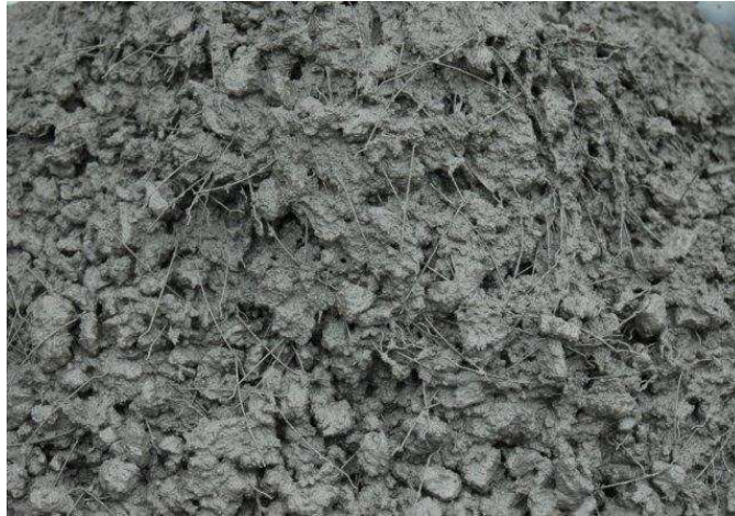
Obr. 2.3: Čerstvý beton s ocelovými drátky [21].
