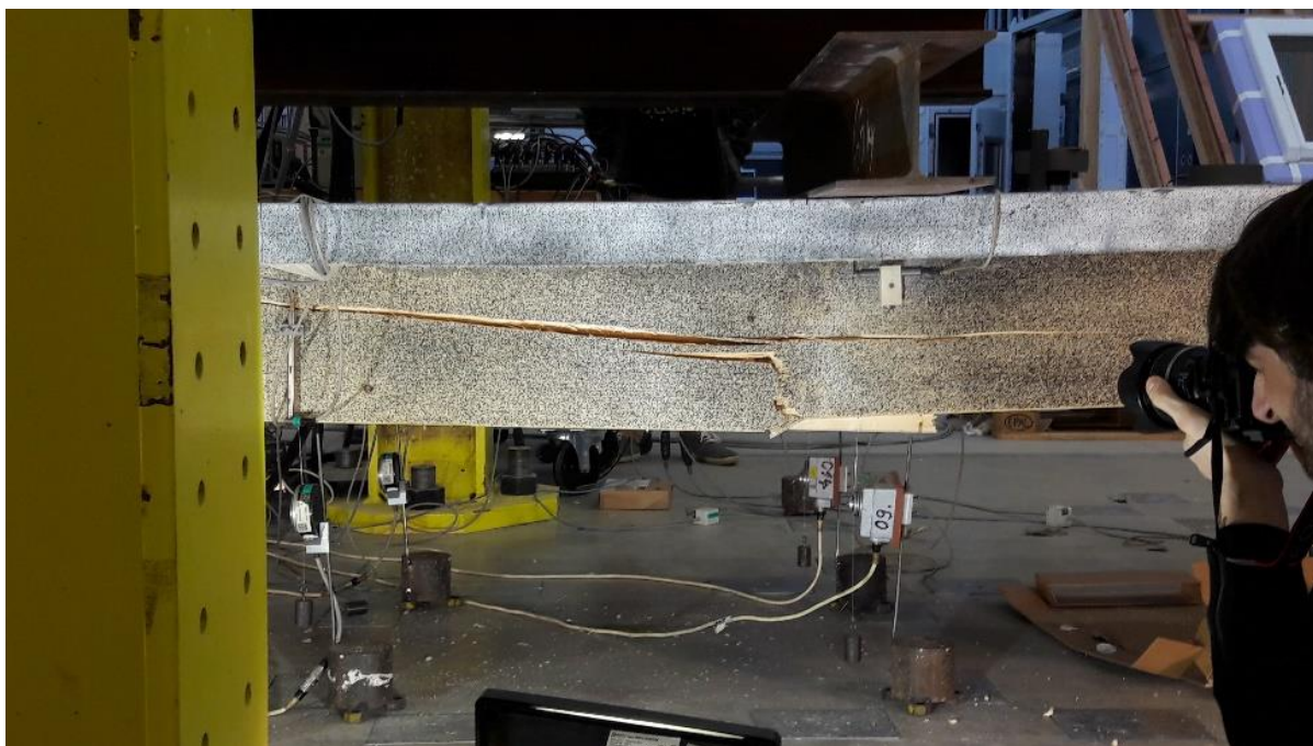
Obr. 3.8: Průběh trhliny v trámu pozorovaném metodou DIC.
