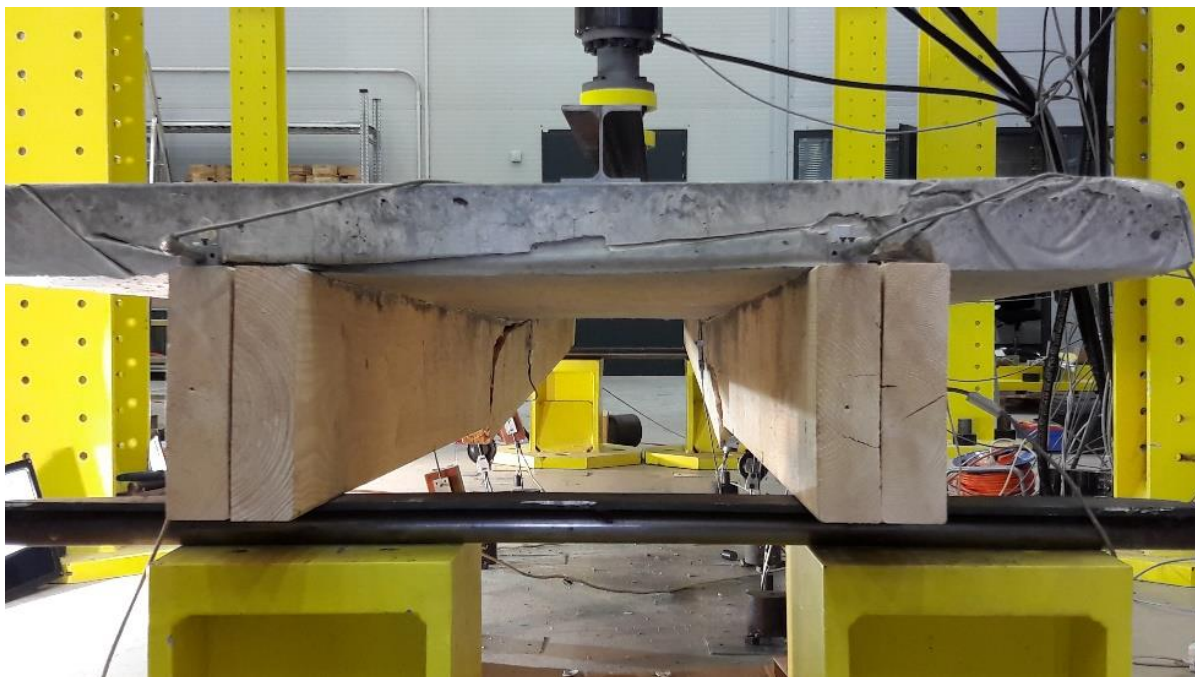
Obr. 3.10: Pohled na průběh trhlin v dřevěných trámčích z profilu nosníku.
